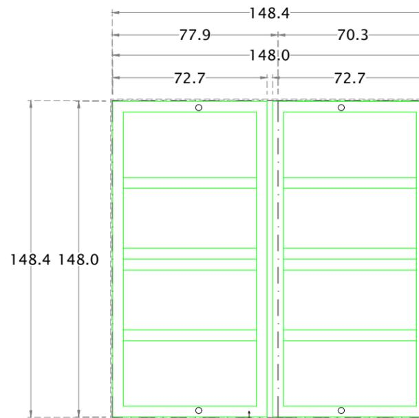
VISTA EN PLANTA ARMADURA DE LA TAPA
